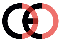
Marcatura CE contraffatta (troppo vicino)
